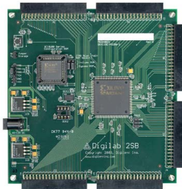
Figura 1. Modulul de dezvoltare D2SB
